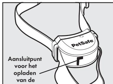
De oplader van de ontvangerhalsband kan op een standaard stopcontact worden aangesloten. Het rode lampje op de ontvangerhalsband gaat branden zodra de oplader goed op het aansluitpunt is aangesloten. Zodra het opladen voltooid is, gaat het groene lampje branden. Een ingebouwd veiligheidscircuit voorkomt het overladen van de ontvangerhalsband.
