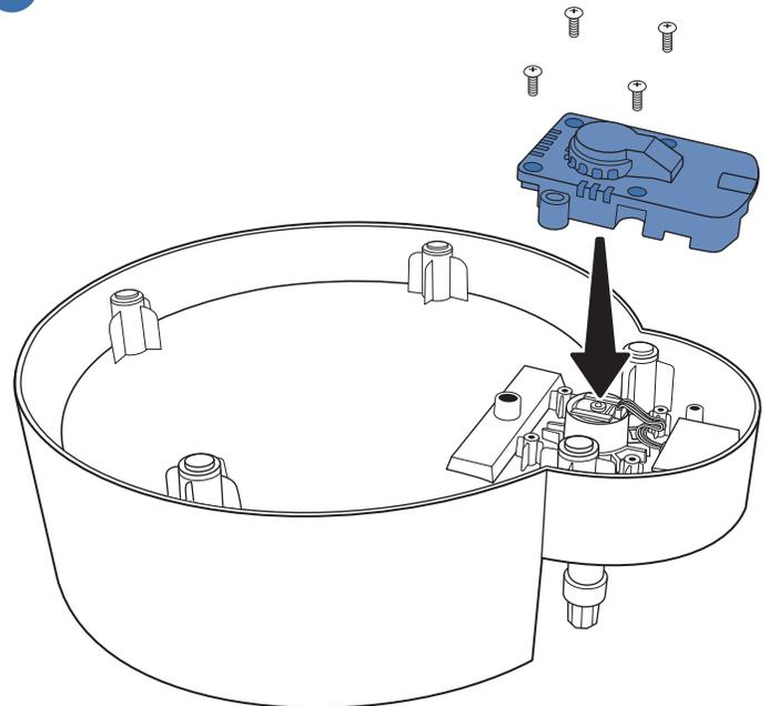
Bringen Sie die Motorabdeckung wieder an und befestigen Sie sie mit den vier zuvor entfernten Schrauben.
