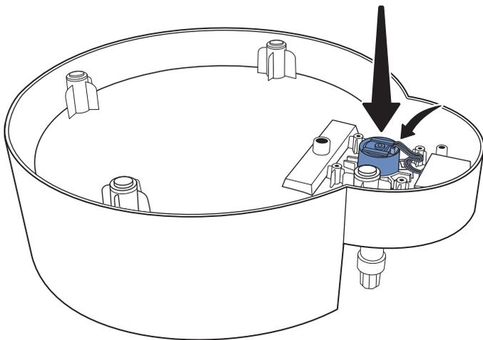
Placera den nya maskinen på fontänbasen och positionera den så att kabeluttaget är bredvid bandkabeln.
