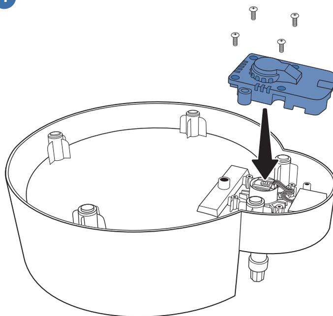
Riposizionare il coperchio del motore e fissarlo con le quattro viti rimosse in precedenza.
