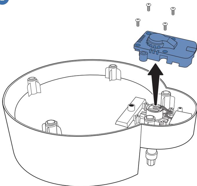
**Ważne:** Przed wymianą silnika odłącz fontannę od prądu.
