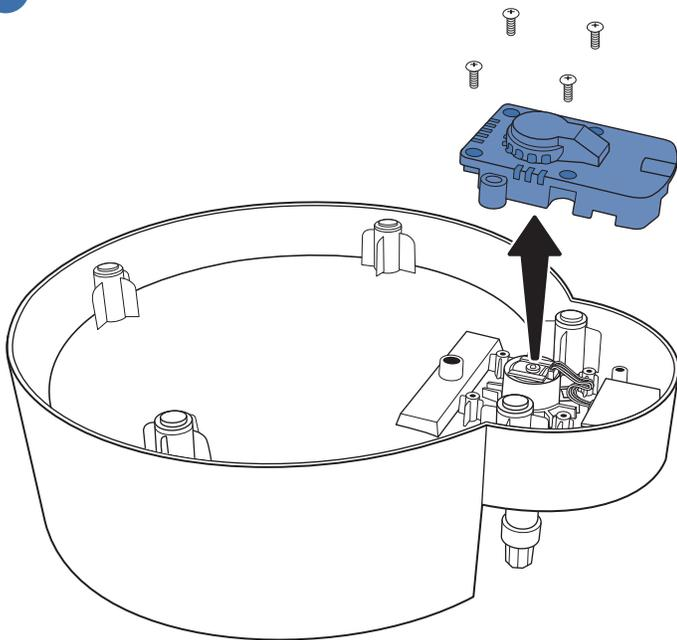
**Importante:** Desenchufe la fuente antes de reemplazar el motor. Retire el cuenco de la base de la fuente. Dé la vuelta a la base de la fuente y colóquela sobre una mesa, asegurándose de que la varilla esté fuera del borde de la mesa.
