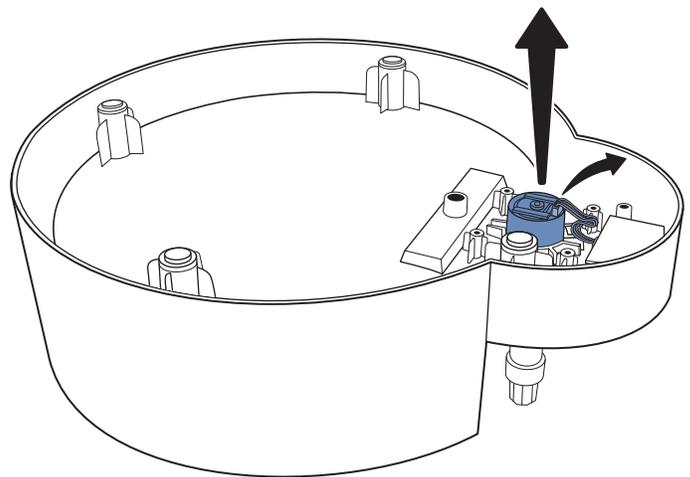
Desconecte con cuidado el cable plano del motor. Levante el motor viejo para sacarlo de la base de la fuente.
