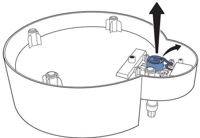
Scollegare con attenzione il cavo a nastro dal motore. Rimuovere il motore usato dalla base della fontana.
