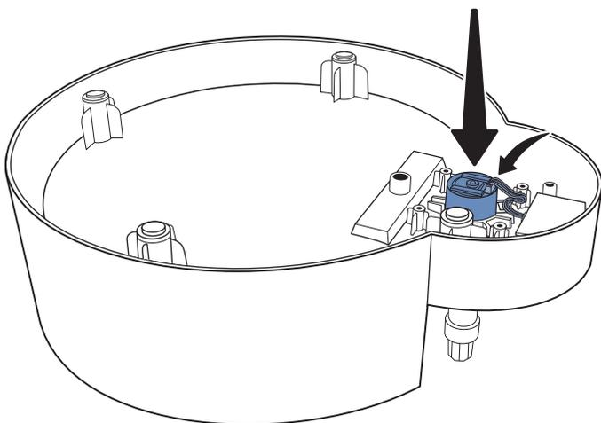
Posizionare il nuovo motore sulla base della fontana, quindi sistemarlo in modo che la presa del cavo sia accanto al cavo a nastro.
