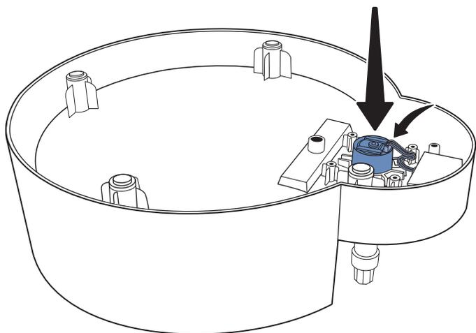
Placer den nye motor på fontænenes fod, så kabelstikket er placeret ved siden af båndkablet.
