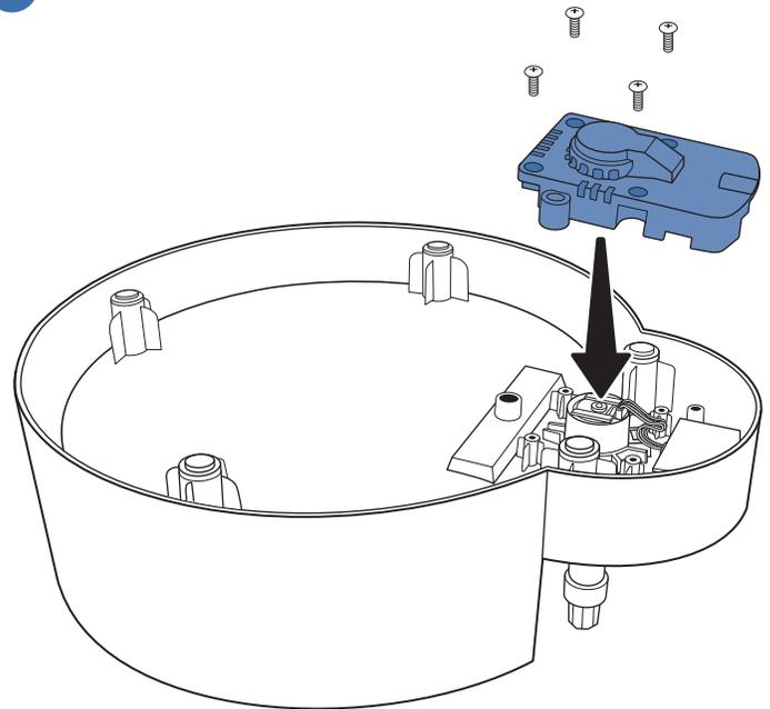
Vuelva a colocar la tapa del motor y asegúrela con los cuatro tornillos que quitó anteriormente.
