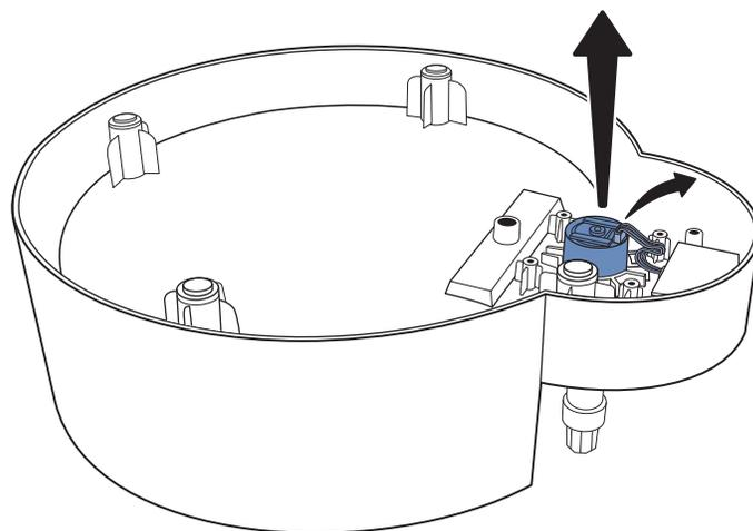
Ostrożnie odłącz kabel taśmowy od silnika. Wyjmij stary silnik z podstawy fontanny.
