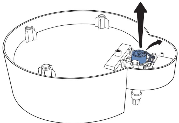
Løsn forsigtigt båndkablet fra motoren. Løft den gamle motor ud af fontænen fod.
