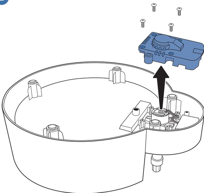
**Belangrijk:** Haal de stekker van de fontein uit het stopcontact voordat je de motor vervangt.
