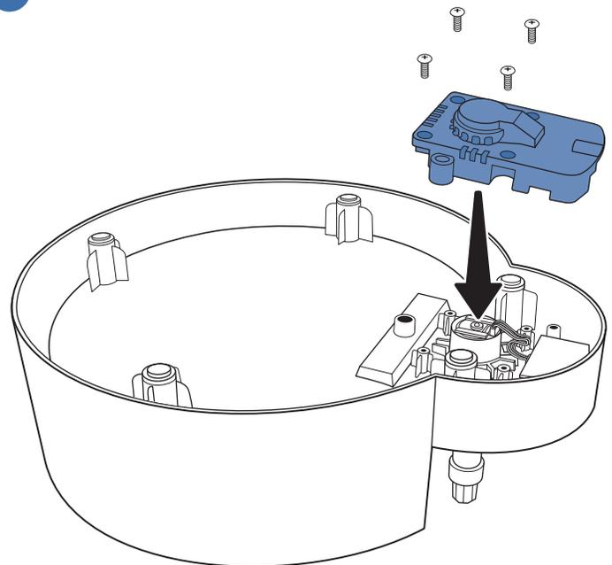
Sätt tillbaka maskinkåpan och fäst den med de fyra skruvarna du tog bort tidigare.
