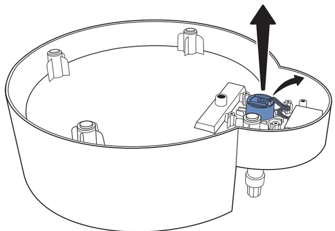
Koppel de lintkabel voorzichtig los van de motor. Til de oude motor uit de fonteinbasis.
