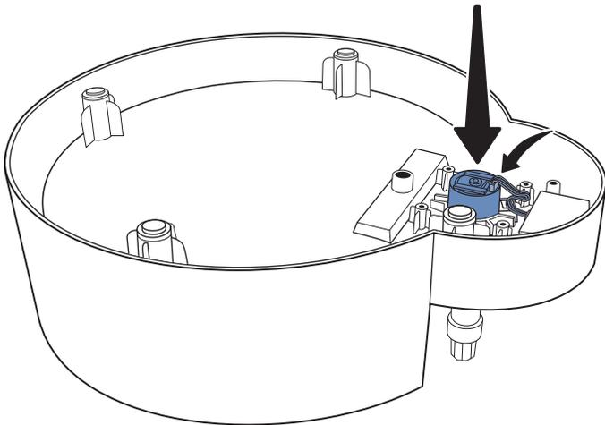
Setzen Sie den neuen Motor auf den Sockel des Trinkbrunnens und richten Sie ihn so aus, dass sich die Kabelbuchse neben dem Flachbandkabel befindet.
