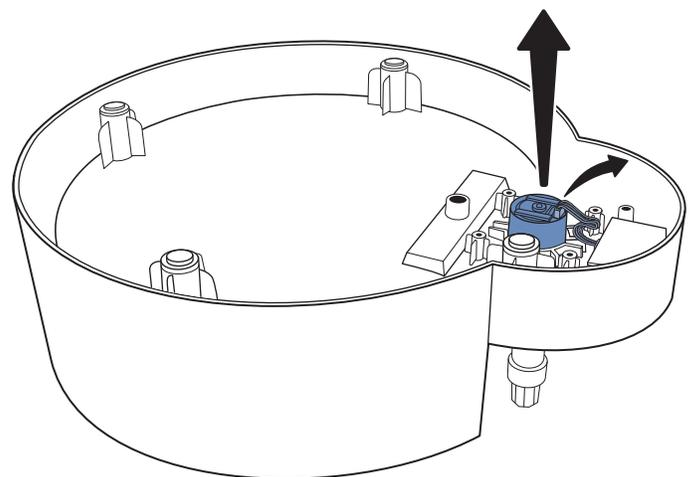
Ziehen Sie das Flachbandkabel vorsichtig vom Motor ab. Heben Sie den alten Motor aus dem Sockel des Trinkbrunnens.
