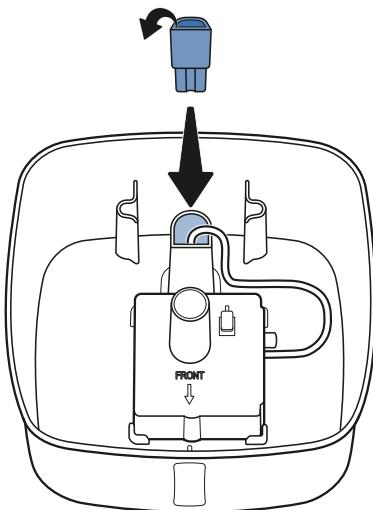
**IT** Inserisci il tappo di silicone sulla parte superiore del tubo premendolo verso il basso. In questo modo il cavo di alimentazione rimane in posizione e si evitano perdite.
