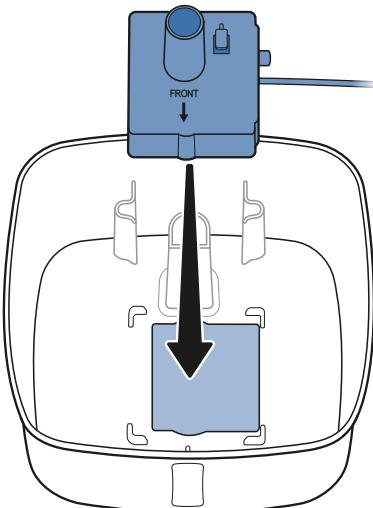
**ES** Coloque la caja de la bomba (con la bomba y el filtro de espuma) en la zona con pestañas dentro del cuenco. La flecha de la caja de la bomba debe apuntar hacia la parte frontal del cuenco.
