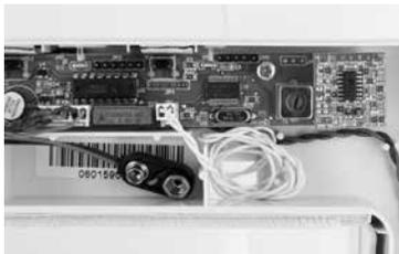
Sæt ledningen fra vindfanget fast på elektronikkortet, og spænd den udvendige og indvendige sektion sammen med de to M6-skruer. Spænd skrueerne, så de holder Petporte smart flap® fast på det ønskede sted inde i åbningen.
