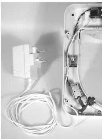
Liitä pienjännitelähteen liitin elektronikkalevyyn ja vie virtajohto pidikkeiden läpi ja alaosan pohjassa olevan aukon läpi.
