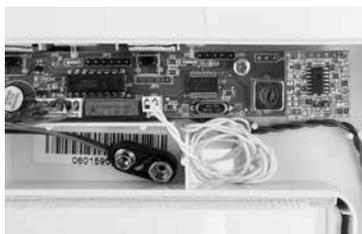
Присоедините разъем кабеля козырька к электронной плате и скрепите вместе внешнюю и внутреннюю секции двумя винтами М6. Затяните винты, чтобы они удерживали дверцу Petporte smart flap® на отверстии в нужном положении.
