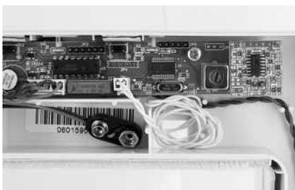
Sæt ledningen fra vindfanget fast på elektronikkortet som vist. Eventuel overskydende ledning skal føres til højre for batterirummet.
