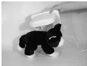
Starta Petporte smart flap®, programmera in din katt som visat på sidan 27 och låt Petporte smart flap® passera över din katt på ett avstånd som din katt normalt skulle närma sig den för att kontrollera att den kommer att fungera för din katt.
