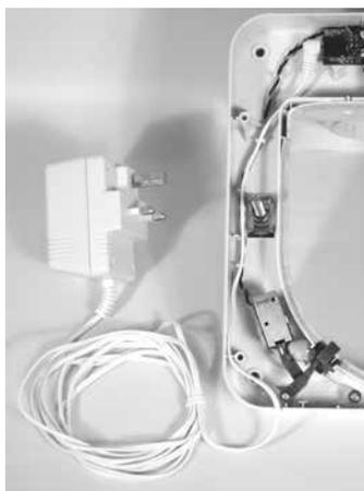
Присоедините низковольтный блок питания к электронной плате, а затем проведите шнур электропитания через зажимы и наружу через отверстие в нижней части внутренней части дверцы.
