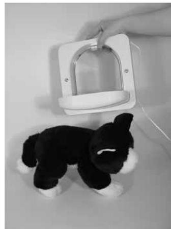
Alternativt kan du hålla Petporte smart flap® upp och ner för att programmera din katts mikrochip.
