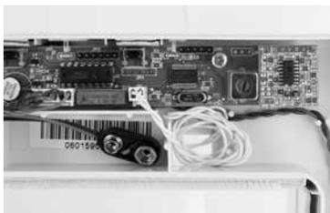
Anslut portalkabeln till kretskortet och håll de utvändiga och invändiga delarna samman med de två M6-skruvorna. Dra åt skruvarna för att hålla Petporte smart flap® i önskat läge i öppningen.
