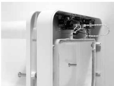
Fäst tillfälligt portalen och den utvändiga delen vid den inre delen med två M6-skruvarna.
