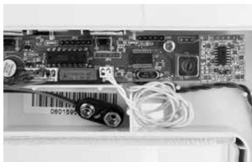
Fest utspringkabelen til elektronikkortet og hold den utvendige delen og den innvendige delen sammen med de to M6-skrueene. Stram skruene for å holde Petporte smart flap® fast i ønsket stilling i åpningen.
