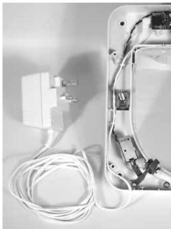
Fest kabelen med lavspenningsforsyning til elektronikkortet og før strømkabelen i sporene og ut av åpningen i bunnen av den innvendige delen.
