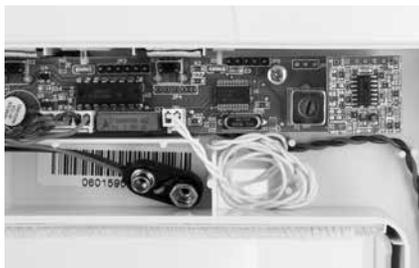
Fest utspringkabelen til elektronikkortet som vist. Overflødig kabel må føres til høyre for batterirommet.
