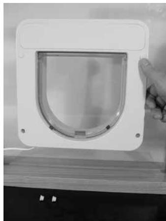
Når sektionerne er sat på plads, påsættes den store dækplade med de fire selvskærende fikseringsskruer. Klik den lille dækplade på plads. Anbring alle blændeopperne, fire små uden på de selv-skærende fikseringsskruer, og to store blændeopper til M6-skrueerne. Til slut sættes der strøm på din Petporte smart flap®.
