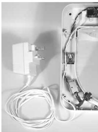
Slut stikket til lavvoltageforsyningen til elektronikkortet, og før el-ledningen gennem klipsen og ud af åbningen i bunden af den indvendige sektion.
