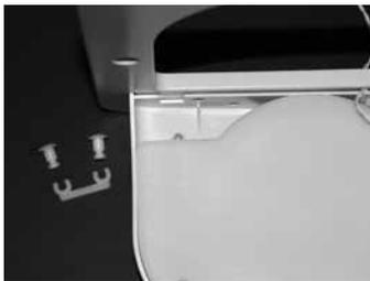
Fest «hestesko»-klipsene til de fire «sopp»-pinnene på undersiden av utspringet.
