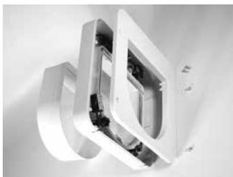
Снимите удлинитель туннеля с внутренней части дверцы. Ослабьте четыре самонарезных фиксирующих винта на внутренней части дверцы и снимите большую прикрывающую пластину.
