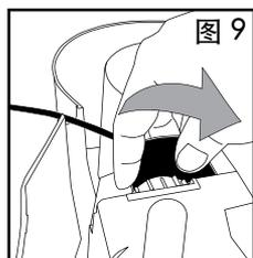
2. 在旋转水泵四分之一圈后，其应与水槽底座平齐（图 9）。翻转水槽。
