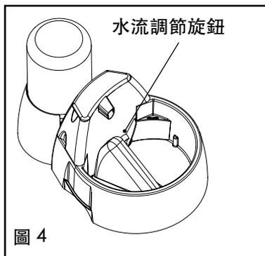
10. 利用緊鄰著水盆內接水斜面板的水流調節旋鈕來設定所需流速。當水流調節旋鈕設於 10 點位置時，流速最低。當水流調節旋鈕設於 2 點位置時，流速最高（請參看圖 4）。
