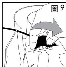
2. 水泵在轉動四分之一圈之後，現在將與水盆底部齊平（圖 9）。把水盆往回翻轉。
