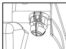
5. 用一隻手將這些部件固定於原處，同時用另一隻手連接機體（請參看圖 12）。透過以下方式連接機體：將機體壁上的密封凹槽向下滑動到水流調節旋鈕與定子之間的位置。當側面鎖扣插入到水盆中時，機體將卡到位（請參看圖 13）。
