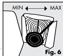
13. Añada el agua necesaria al cuenco y al depósito. No deje que el nivel del agua caiga por debajo del mando regulador de caudal; de lo contrario, podría producirse un fallo de la bomba. Puede adquirir bombas de repuesto por separado poniéndose en contacto con el Centro de atención al cliente. Para obtener una lista con el número de teléfono del Centro de atención al cliente más cercano visite nuestro sitio web [www.petsafe.net](http://www.petsafe.net).
