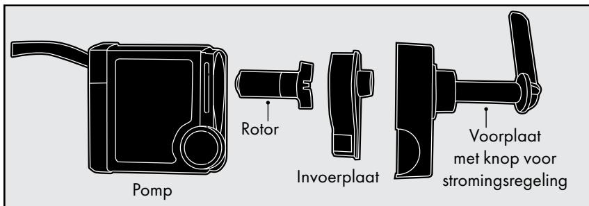
1. Verwijder het voorfilter en de behuizing van de bak.
