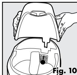
7. Rimuovere la pompa dalla propria cavità ponendo il dito indice dietro la pompa e afferrando la parte inferiore della pompa con il pollice.
