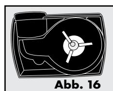
5. Wenn Sie die Ansaugplatte entfernt haben, können Sie das magnetisch fixierte Antriebsrad abnehmen (weißer Propeller mit drei Flügeln). Führen Sie dazu einen Fingernagel unter ein Blatt und heben Sie das Antriebsrad aus der Pumpe heraus (**Abb. 17**).
