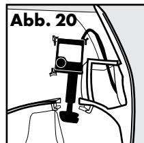
2. Fädeln Sie den Inline-Stecker des Netzkabels durch das Loch neben der Pumpe. Damit der Trinkbrunnen stabil ist, führen Sie das Netzkabel durch die Kabelkanäle und die Kerbe an der Unterseite des Trinkbrunnens (**Abb. 21 & 22**).
