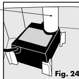
4. Riposizionare il prefiltrato sulla manopola per il controllo del flusso facendo scivolare il lato stretto per primo. Il bordo sulla parte superiore del prefiltrato deve essere rivolto verso la parte anteriore della fontana per animali domestici.
