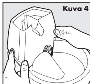
**Tärkeää:** Virtaussäätönuppi on kiinnitetty pumppuun. Älä yritä irrottaa pumppua virtaussäätönupista vetämällä, sillä se voi vaurioittaa pumppua tai pumppu voi rikkoutua.
