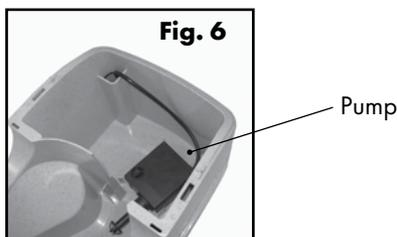
7. Lyft pumpen rakt upp; du kan behöva ta i lite för att sugkopparna ska lossna.
