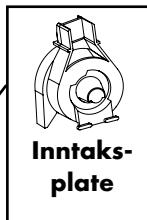
4. Sett sammen flytjusteringsknappen og inntaksplaten ved å plassere flikene på flytjusteringsknappen i gjennomføringen på inntaksplaten (**Fig. 12-13**).
