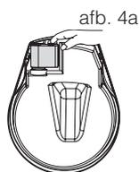
b) Nu dat de motor ontgrendeld is, verwijdert u deze van de fontein verwijderen. Als u het moeilijk vindt om dit te doen, kunt u de motor naar buiten duwen van de komzijde.
