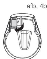
c) Til voorzichtig de rotor (de witte propeller) op uit de motor. Die zou er zonder moeite moeten uitglijden. Verwijder haar dat er eventueel rondgedraaid zit en was de rotor met de andere onderdelen.
