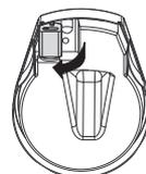
d) Versez de l'eau savonneuse dans la cavité du moteur et nettoyez-la avec une petite brosse ronde à poils raides (kits de nettoyage disponibles). Rincez soigneusement et remettez en place la turbine propre.
