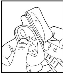
Cette commande de marche / arrêt fonctionne uniquement lorsque la télécommande et le collier sont proches l'un de l'autre. Elle ne fonctionne pas à distance. N'allumez ou n'éteignez jamais le collier lorsqu'il est placé sur votre chien.
