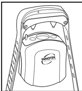
Eine Stelle in der Nähe der Tür wählen, die Sie und Ihr Hund regelmäßig benutzen und die Ladestation in eine Steckdose einstecken. Das Halsband in der Ladebasis positionieren. Es liegt richtig, wenn die Kontaktstifte nach unten durch die Löcher zeigen. Ein eingebauter Sicherheitsstromkreis verhindert ein Überladen. Die Leuchte am Halsband leuchtet rot, wenn es richtig positioniert ist und lädt, und wechselt auf grün, wenn es voll geladen ist.
