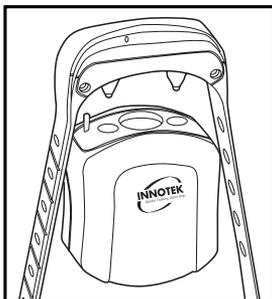
Scegliere un posto vicino ad una porta che l'utente e il cane usano regolarmente e inserire il caricabatterie nella presa murale. Posizionare il collare nel supporto di carica. Il collare va inserito nel supporto con le sonde rivolte verso il basso attraverso i fori del contenitore. Un circuito di sicurezza interno evita il sovraccarico dell'unità. La spia del collare s'illumina di rosso quando il collare è collocato correttamente e in carica; diventerà verde quando la carica è completa.
