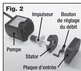
Tenez la plaque d'entrée entre le pouce et l'index et tirez pour la retirer. Retirez le bouton de réglage, le stator et l'impulseur. Pour retirer l'impulseur, soulevez-le avec votre ongle; il est maintenu en place par un aimant.
