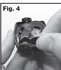
Remettez le bouton de réglage du débit en l'insérant dans le trou situé sur le moteur de la pompe. Alignez le bouton avec l'ouverture de la plaque d'entrée et refermez la plaque.
